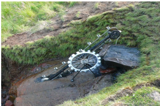
Mynd 12: Drifvatn hjólsins tengt vatnsveitu
