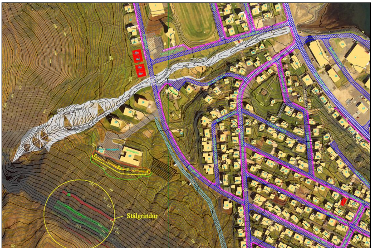
Teikning verkfræðihönnuða, yfirlit stöðvirkja og varnargarða meðfram bæjarlæknum.
