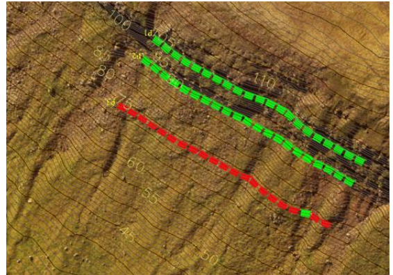
Teikning stoðvirkjalína snjóflóðavarna í Ólafsvík.
