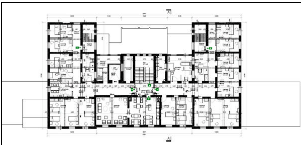
Grunnmynd 2. hæðar. Teikning THG ehf.
